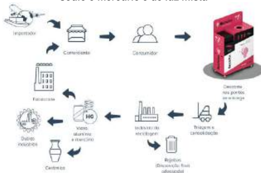
Figura 28 – Logística reversa de lâmpadas fluorescentes, de vapor de sódio e mercúrio e de luz mista
